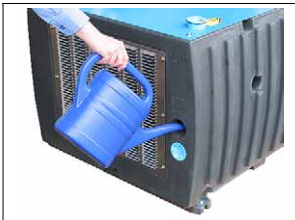
Obr. 8: Plnění odlučovače Typy 2BL2 251 - 341 (přes plnicí otvor)
