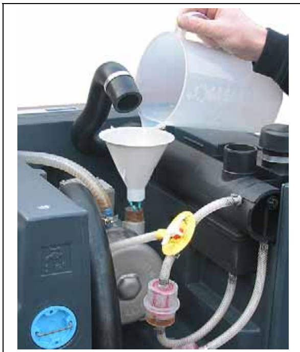
Obr. 13: Plnění konzervačního prostředku / odvěpňovací kapaliny do zabudovaného agregátu (pro typy 2BL2 041 - 2BL2 141)
