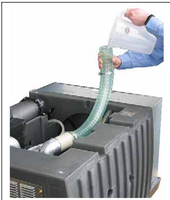
Obr. 14: Plnění konzervačního prostředku / odvěpňovací kapaliny do zabudovaného agregátu (pro typy 2BL2 251 - 2BL2 341)
