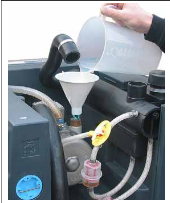
Fig. 13: Fylla på konserveringsmedel / avkalkningsvätska i det inbyggda aggregatet (för typ 2BL2 041 - 2BL2 141)
