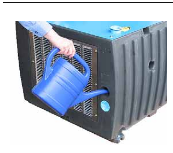
Fig. 8: Fyll på avskiljaren typ 2BL2 251 - 341 (via påfyllningshålen)
