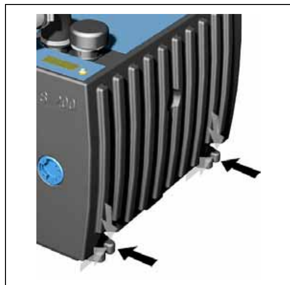
Fig. 4: Ställen för att mäta vibrationshastigheten
