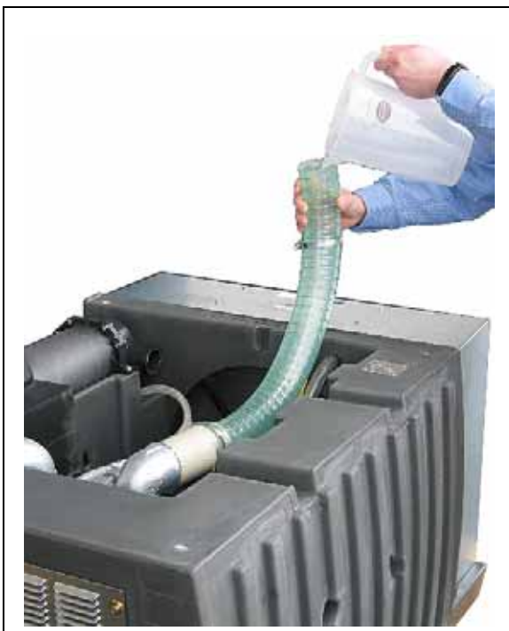
Fig. 14: Fylla på konserveringsmedel / avkalkningsvätska i det inbyggda aggregatet (för typ 2BL2 251 - 2BL2 341)
